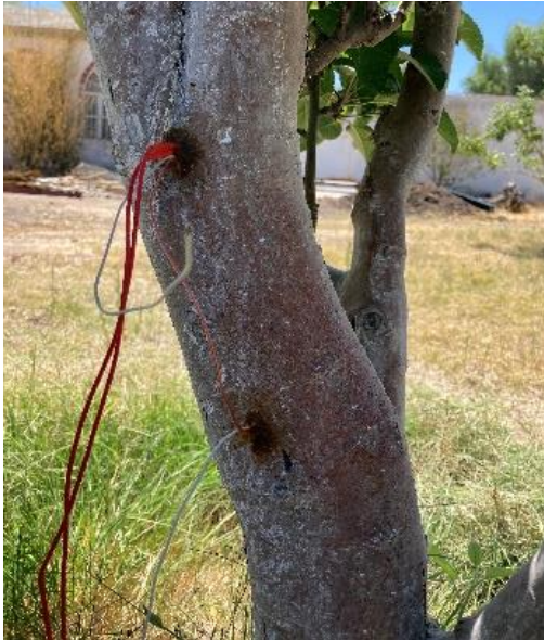
Fig. 6 Instalación de termocupla y calentador
