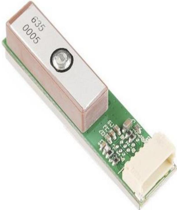
Fig. 2 GPS GP-635t Module.
