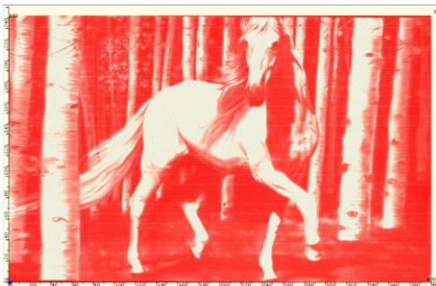
Figura 3. Pre-visualización del proceso de grabado en la aplicación LaserGRBL .
