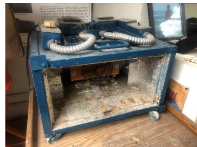
Figura No.4 Máquina para realizar la caracterización de la conductividad térmica de las muestras
