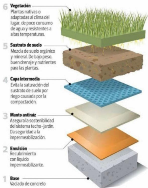
Figura No.1 Componentes de una azotea verde
