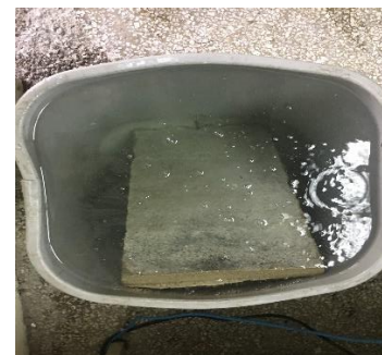
Figura No.5 Cubeta con agua, donde se sumergen las muestras, para la caracterización de impermeabilidad.
