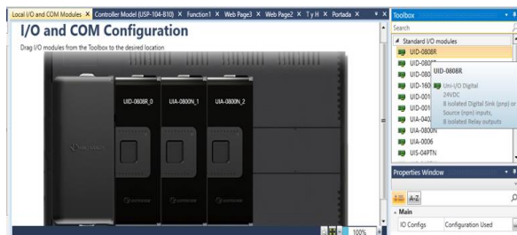
Figura 7 Insertar módulos I/O de señales analógicas y digitales
