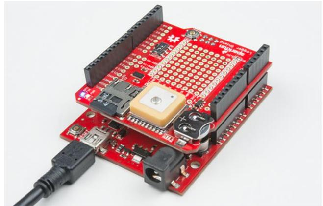
Fig. 6 GPS Logger Shield de SparkFun.
