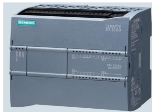
Figura 2 PLC Siemens S7-1200
