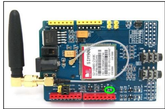
Figura 4. Shield SIM900 para Arduino. Fuente: hetpro-store.com.
