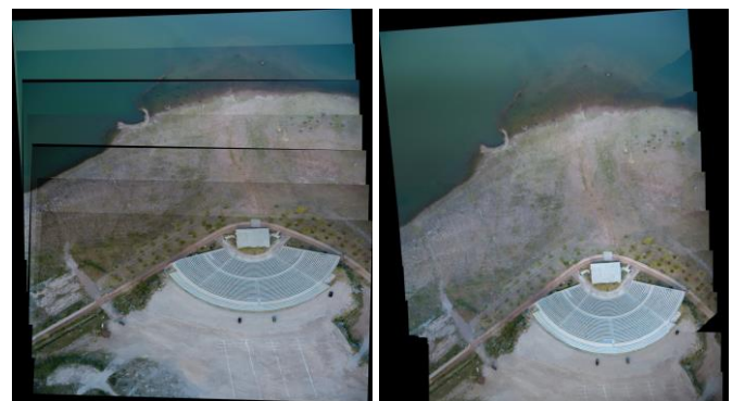
Figura 8. Ortomosaico sin corrección de costura (a) y ortomosaico con corrección de costura (b).
