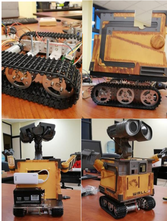
Figura 7. De izquierda a derecha, de arriba abajo: a) etapa de ensamblaje, b) ajustes de ensamblado, c) Posicionamiento de baterías, d) Ensamblado final
