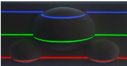
Fig.10. Proyección de patrón de 3 líneas sobre el objeto.
