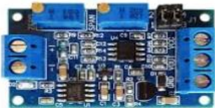
Figura No 5 Sistema de conversión de corriente a voltaje utilizada para la primera versión de hardware-software
