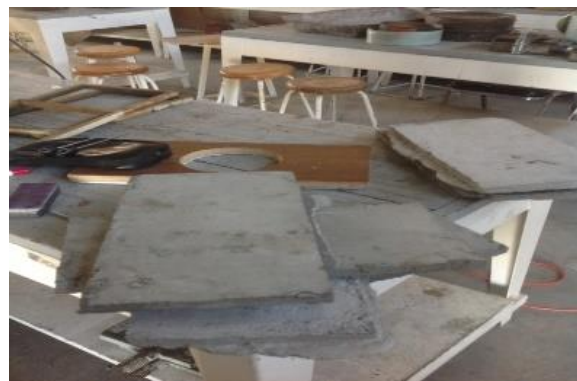
Figura No.3 Bastidores y muestras del pegamento cementado diatérmico
