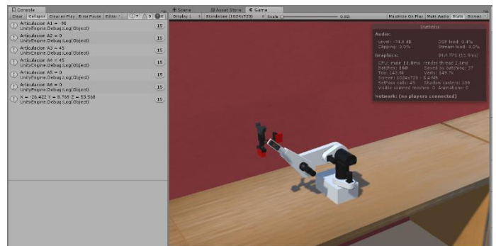
Figura 10: Simulación de movimiento articular del Brazo robótico en Unity 3D (Rotación en: A1 = -90°, A3 = 45° y A4 = 45°)
