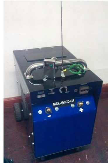
Fig. 5 Máquina de Soldar ahorradora de energía con regulación de corriente de salida en forma inalámbrica.
