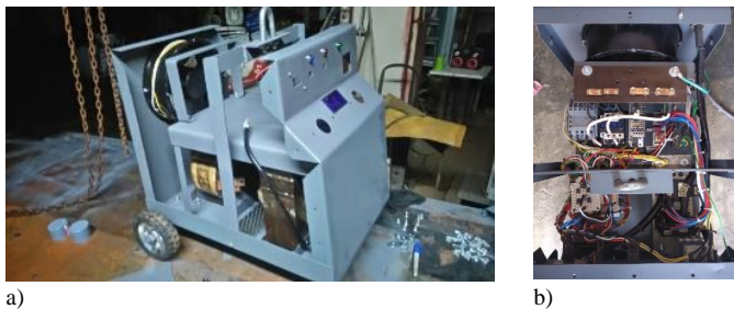
Fig. 4. Ensamblado de la máquina, a) Transformador y estructura de la máquina, b) Componentes electrónicos de control.
