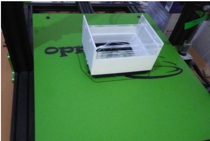
Figura 10: Impresión 3D de la carcasa para el prototipo.
