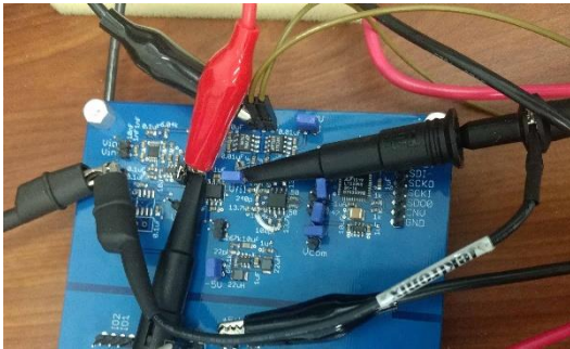
Figura 6. Tarjeta prototipo con las etapas de alimentación, filtro MAX295, filtro/driver pasa-bajas y ADC.
