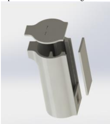
Figura 3. Diseño 3D de protector de nodo.
