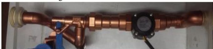
Figura 5. Tubería ensamblada en carcasa.
