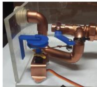
Figura 7. Mecanismo para el accionamiento de la válvula. Una vez que se tenía la carcasa y tubería, se realizó el diseño del circuito para los componentes electrónicos (figura 8).
