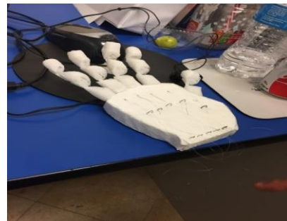
Figura 2. Mano de polímero conectada al Arduino para establecer la comunicación del lenguaje de señas.
