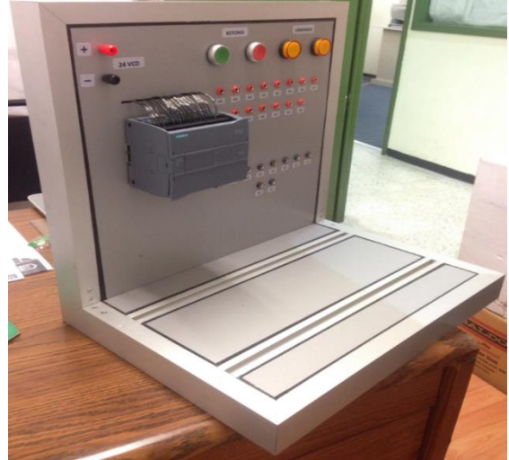
Fig. 6. Panel didáctico con el PLC Siemens S7-1200 [9]
